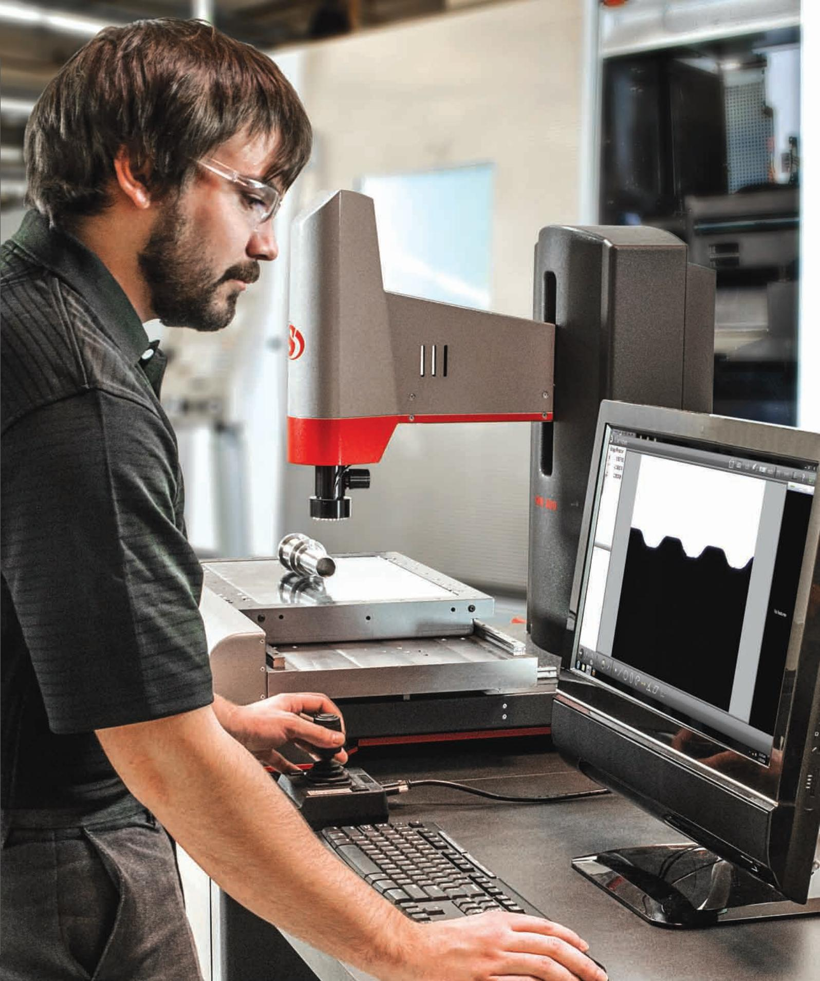
MÁQUINAS DE MEDICIÓN ÓPTICA
